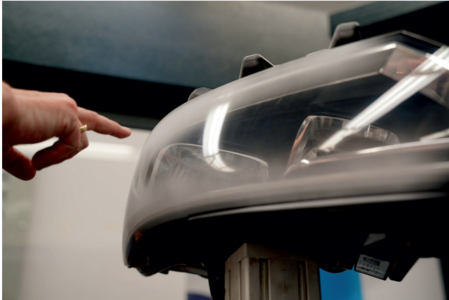
Bild 1. Das aufgetragene AESUB Spray bildet eine weiße, grifffeste Schicht auf der auch Referenzpunkte problemlos halten. © AESUB
